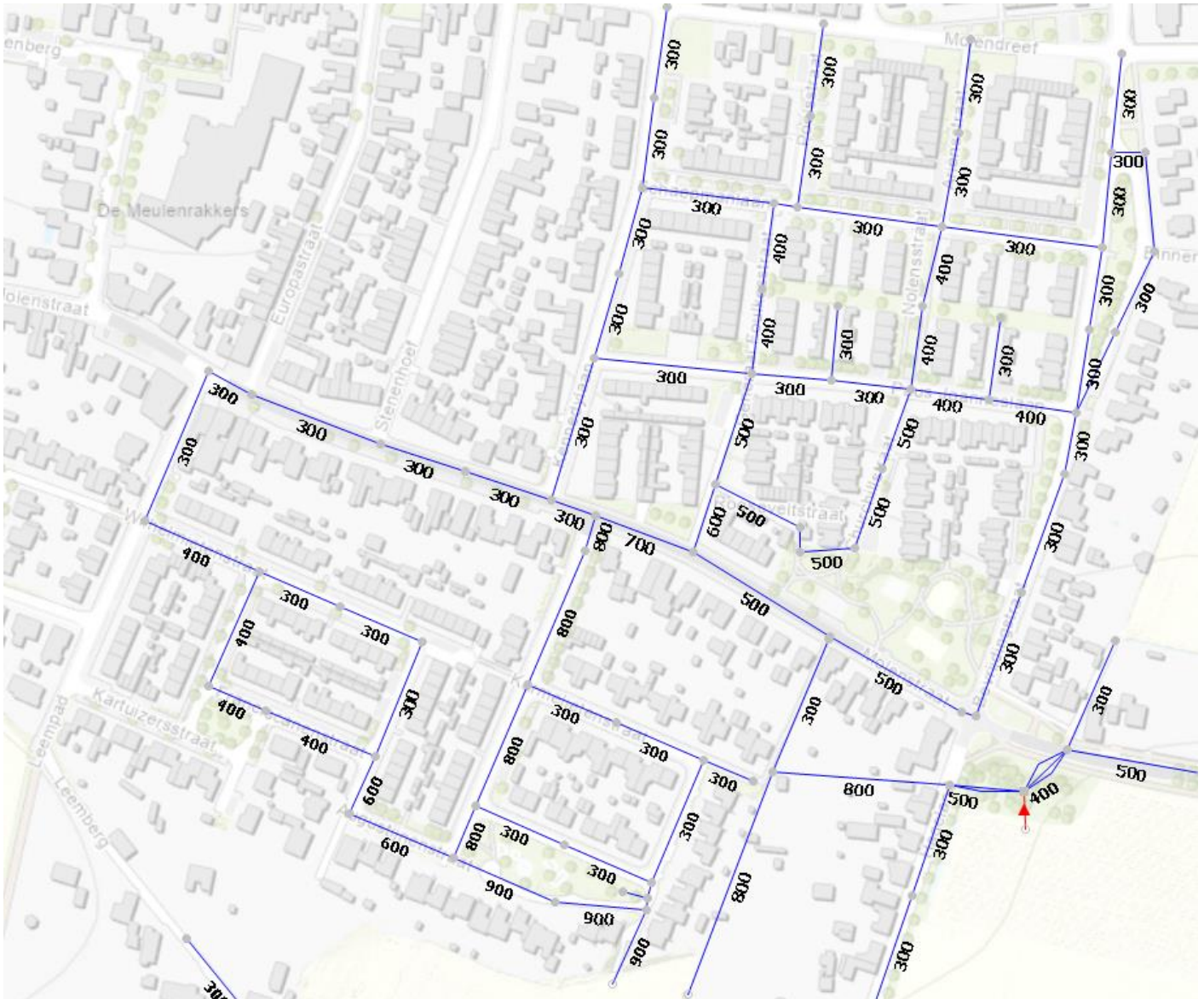
Figuur 8 benodigde diameters voor geen water op straat bij bui 10
