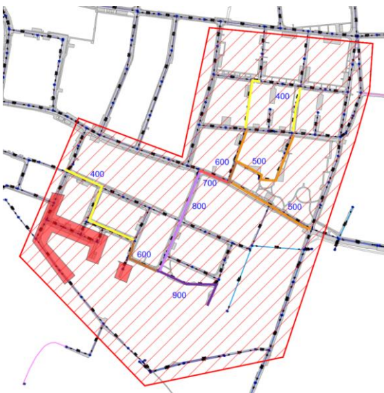
Figuur 7 straten met een te lage maaiveldhoogte ten opzichte van het lozingspunt op de Vossenloop
