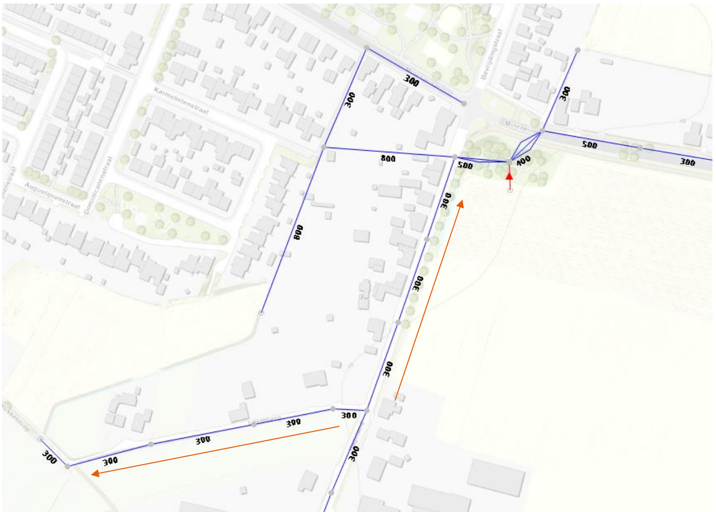
Figuur 4 bestaande RWA-riolering met overkluizing Vossenloop
