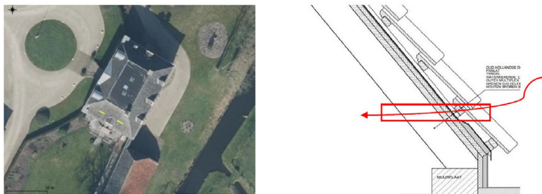
Figuur 7. Indicatieve plaatsing van twee invliegopeningen voor de gewone grootoorvleermuis (links) en vormgeving van de invliegopening, van onder de dakpan, door het dakbeschoot naar de zolderruimte (rechts). De invliegopeningen zijn 5 cm breed en 2,5 hoog en fungeren als doorgang van de buitenlucht, door het dakbeschoot naar de zolder.
