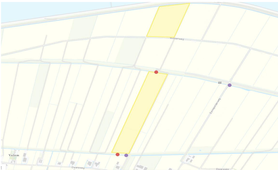
Figuur 1: De rode stippen geven onttrekkingspunten weer. De paarse stippen geven stuwen weer. In geel gearceerd geven te beregenen percelen weer.
