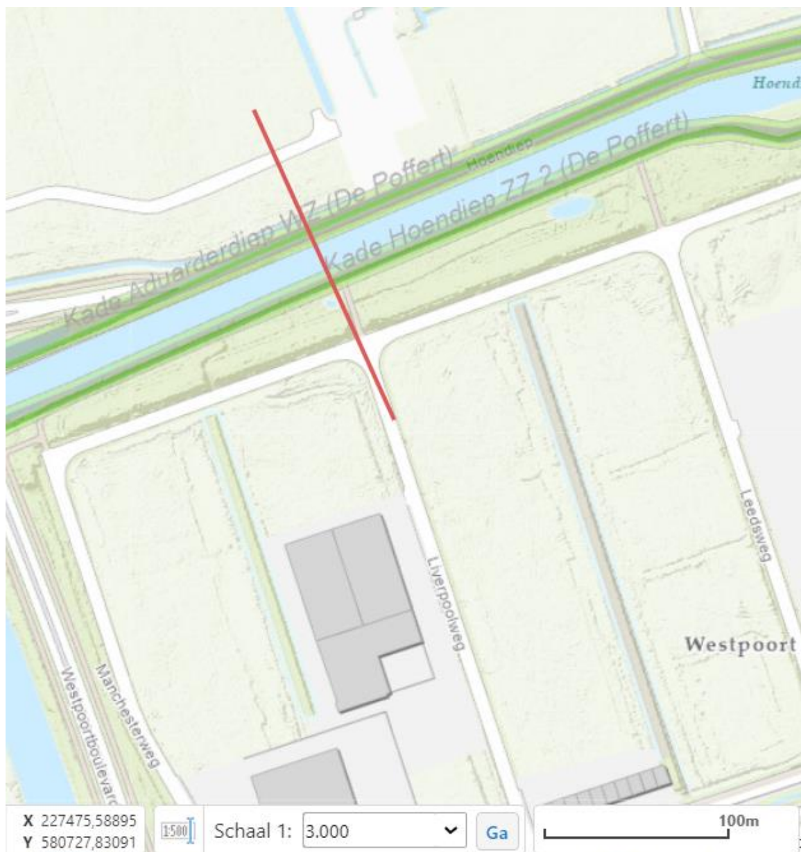
Figuur 1: Schematische tekening van de werkzaamheden. De rode lijn geeft globaal de locatie weer van de te maken gestuurde boring.
