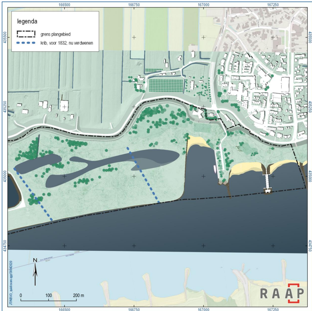
Figuur 8. Inrichtingsvariant 2 bestaande uit een (deels) gegraven strang. Enkel de oostelijke krib (blauwe stippellijn) wordt verstoord.
