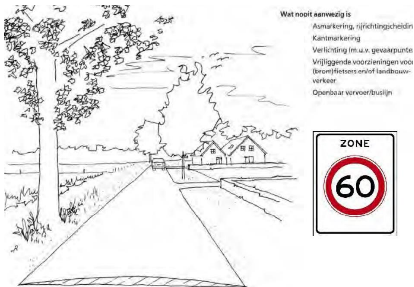
Figuur 2.5: Vormgeving ETW 60 km/h type II (bron: CROW)
