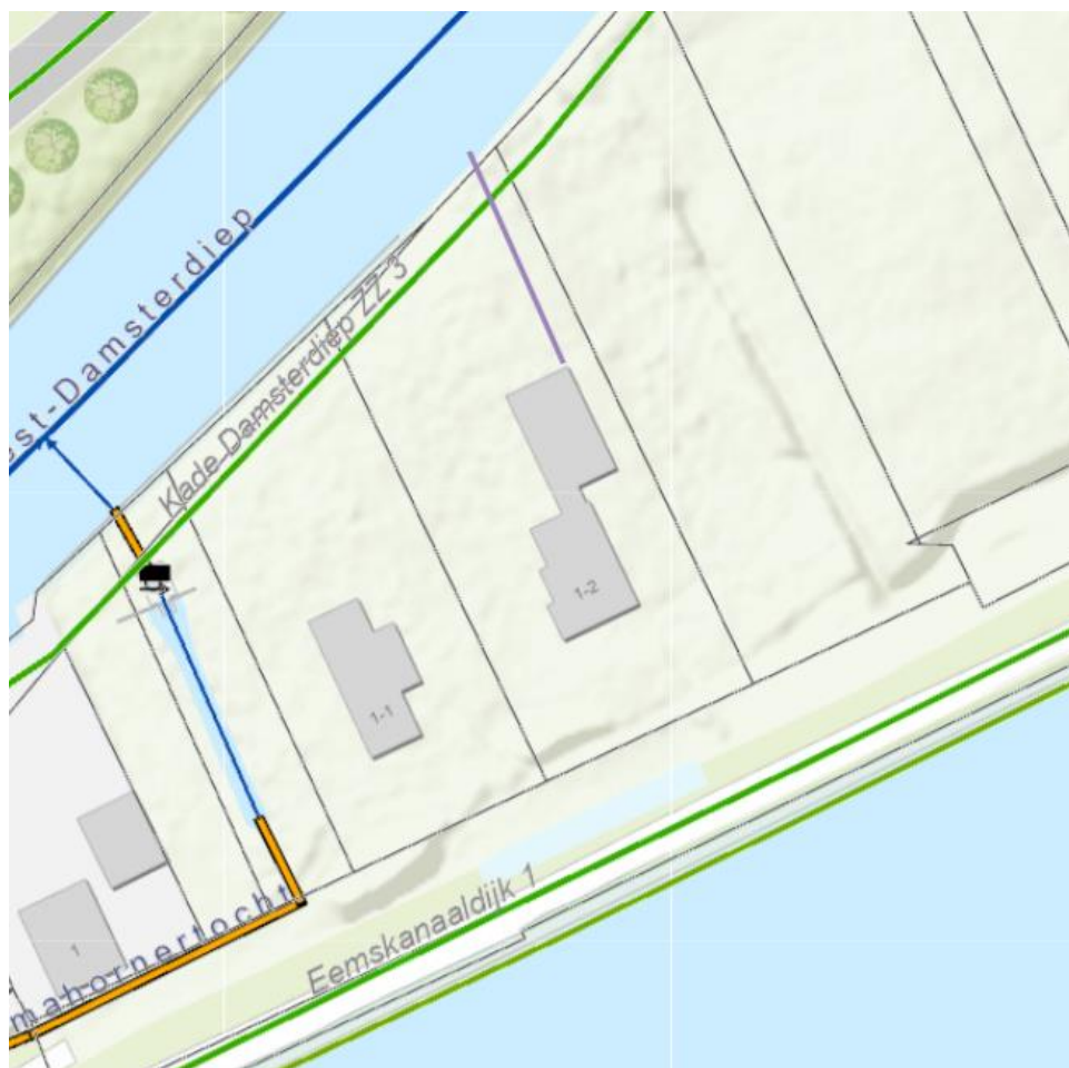
Figuur 1: Schematische tekening van de werkzaamheden. De paarse lijn geeft globaal de locatie weer van de aan te leggen leiding.
