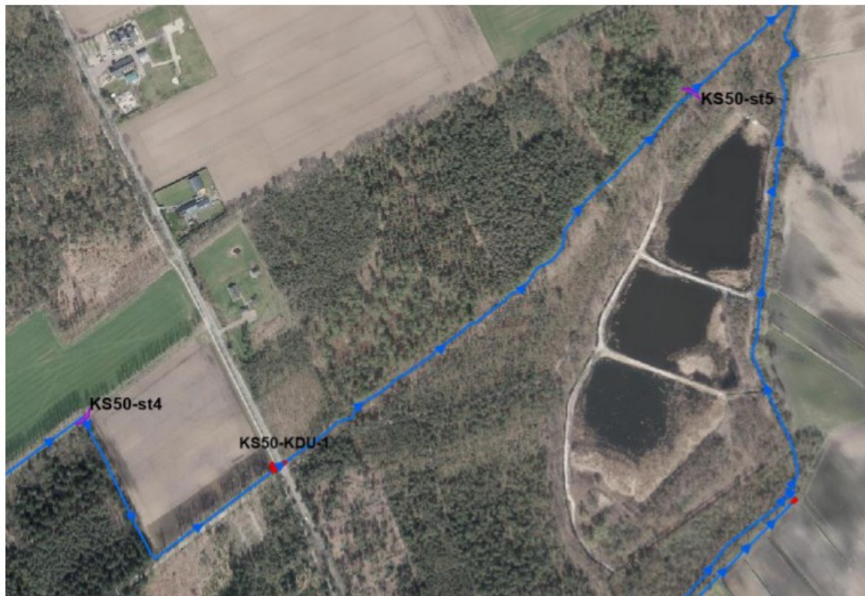
Figuur 1 Situering watergang Keunensloop (KS50). Ter plaatse van de duiker KS50-KDU-1 is een roterende stuw geplaatst. De blauwe peilen geven de stromingsrichting weer
