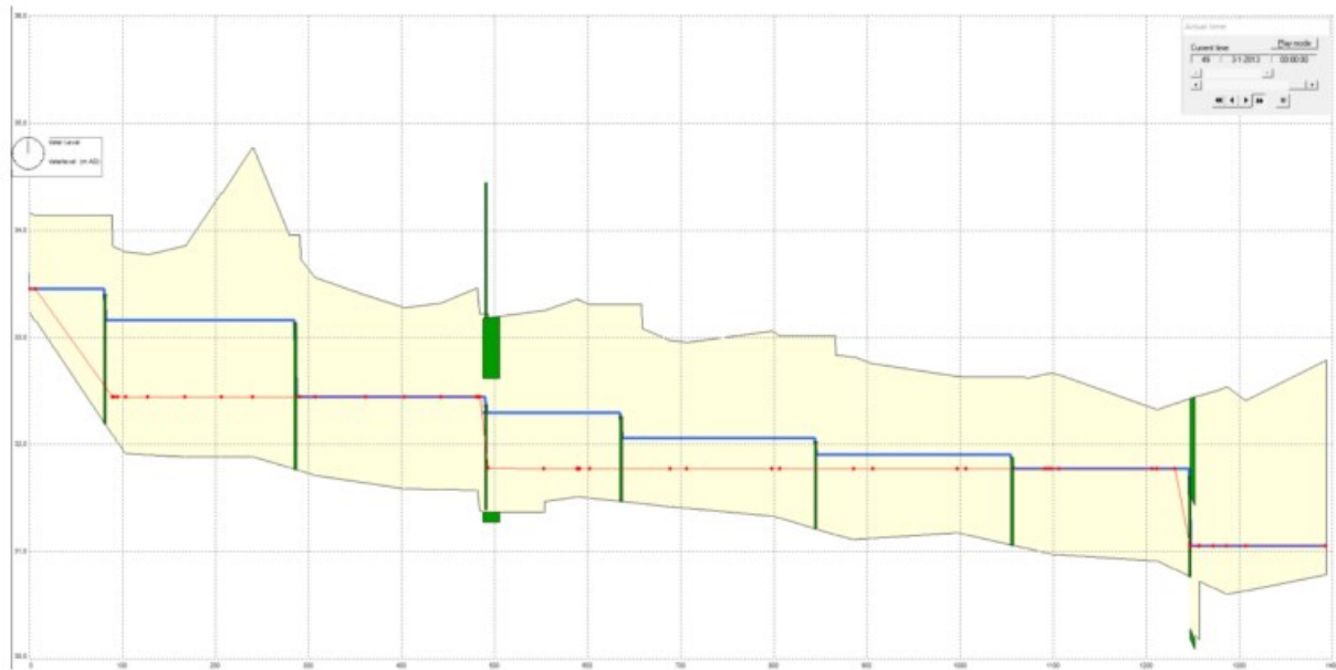
Figuur 6 In blauw het waterpeil met een stationaire winterafvoer met gronddammen en de knijpende constructie. In rood het waterpeil met een stationaire winterafvoer van de referentie situatie
