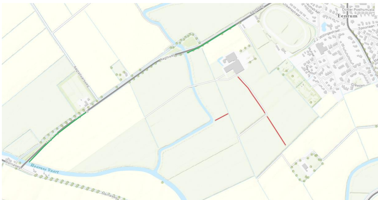
Figuur 1: Locatie van werkzaamheden. De rode lijnen geven te dempen watergangen weer. De groene lijnen geven te verbreden watergangen weer.
