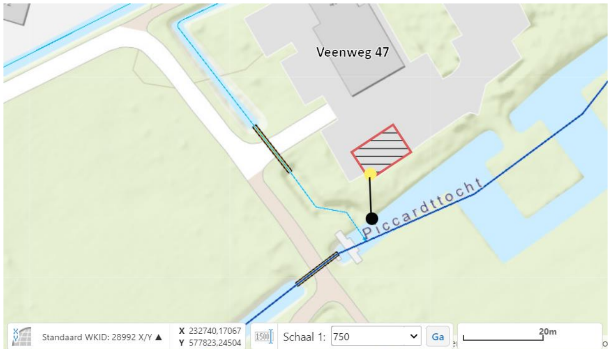
Figuur 1 - Bijlage 2: Rood omlijnde kader geeft de wasplaats weer, gele punt duidt de olie- en benzineafscheider aan en de zwarte lijn en het zwarte punt geven de afvoergoot respectievelijk het lozingspunt weer
