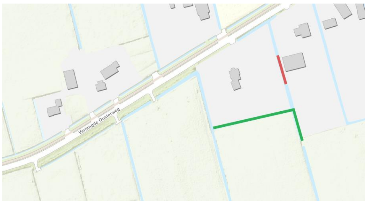
Figuur 1: Locatie van werkzaamheden. De rode lijn geeft locatie weer van de gedeeltelijk gedempte watergang en aan te leggen duiker. De groene lijn geeft te verbreden watergang weer.
