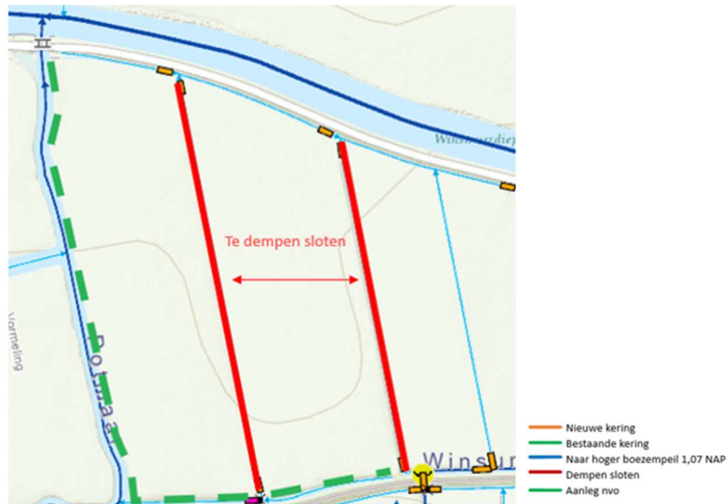
Figuur 2a: Aanleg nvo en te dempen sloten
