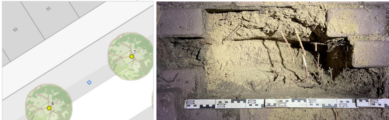
Foto 6. Links: graaflocatie bij blauwe hokje. Rechts: de platanen vullen de hele lengte op tussen boomposities met wortels.
