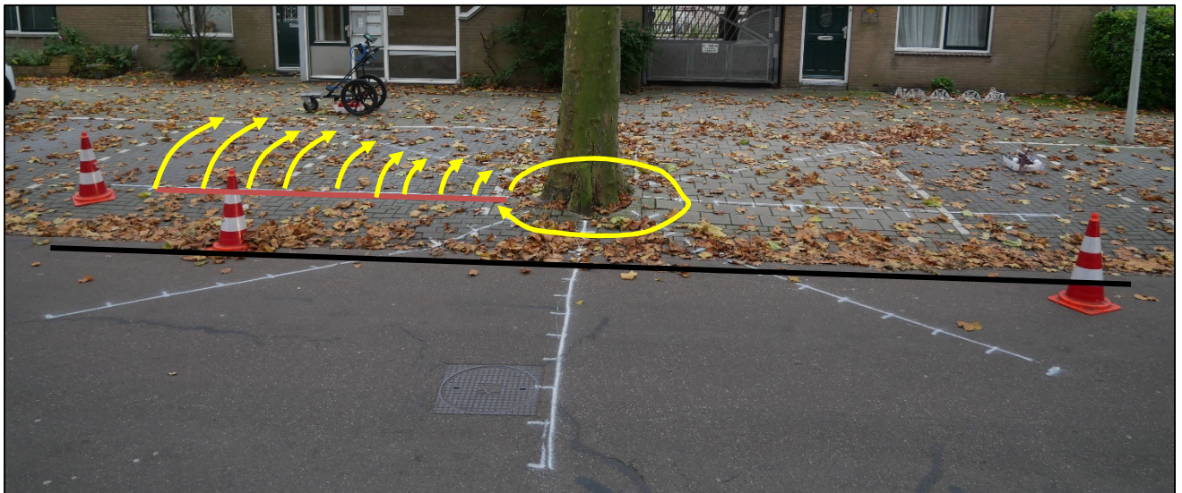
Foto D: Beeld van de gelopen scanlijnen bij de gewone plataan LM24. Met een oranje streep is het beginpunt van de scanlijnen aangegeven. De gele pijlen geven de scanrichting aan. Met een zwarte lijn is de overgang naar asfaltverharding weergegeven, deze lijn is op onderstaand figuur terug te zien.
