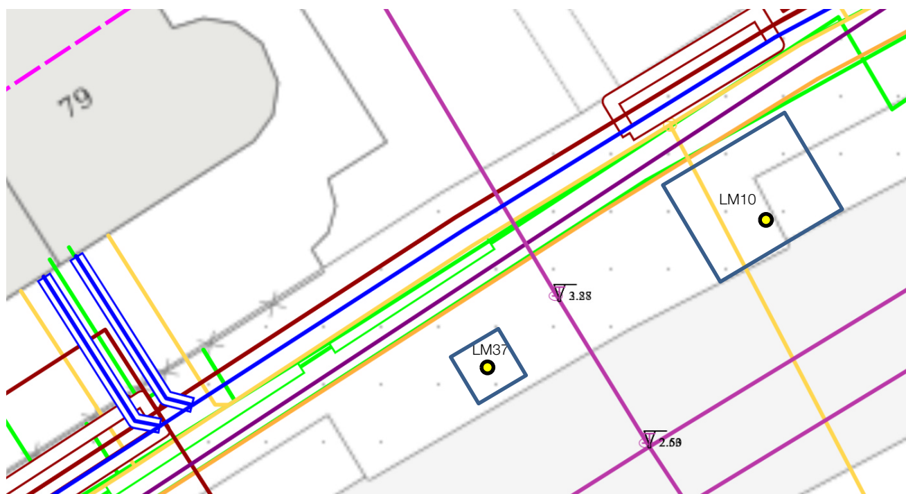
Figuur 3: Posities bomen LM37 en LM10 ten opzichte van kabels en leidingen. Boomposities bij gele stippen. Met blauwe kaders zijn rond de bomen indicatieve maten van verplantkluiten weergegeven.
