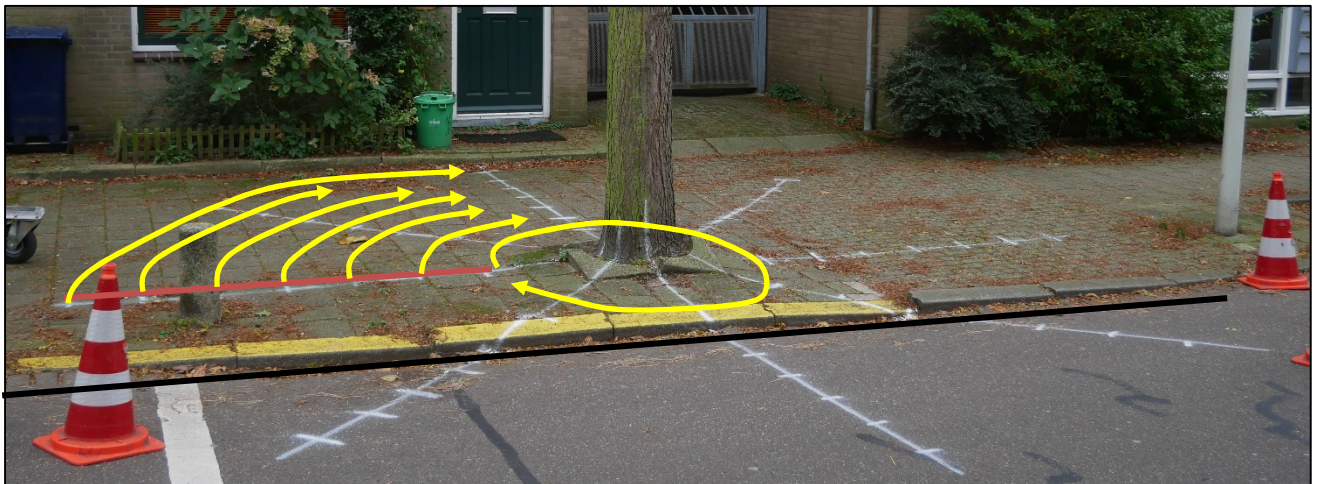
Foto E: Beeld van de gelopen scanlijnen bij de honingboom LM29. Met een oranje streep is het beginpunt van de scanlijnen aangegeven. De gele pijlen geven de scanrichting aan. Met een zwarte lijn is de overgang naar asfaltverharding weergegeven, deze lijn is op onderstaand figuur terug te zien.
