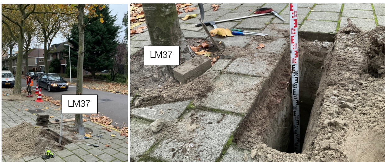
Foto 5. Links: graaflocatie bij plataan LM17 (nabij huisnr. 79). Rechts: de plataan wortelt met een intensieve mat direct onder de tegels.
