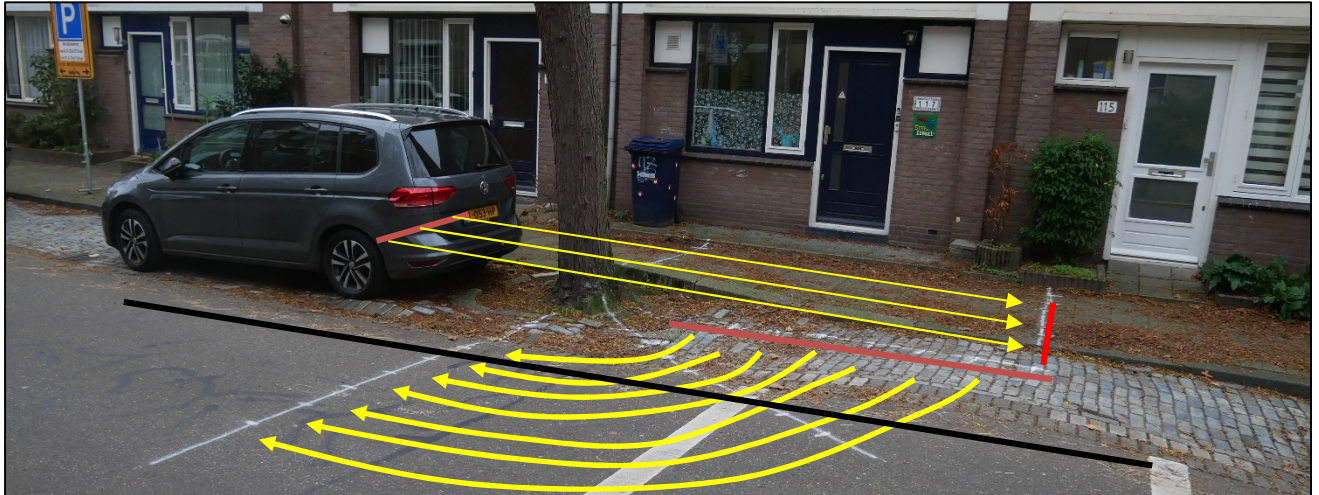
Foto F: Beeld van de gelopen scanlijnen bij de honingboom LM35. Met een oranje streep is het beginpunt van de scanlijnen aangegeven. De gele pijlen geven de scanrichting aan. Met een zwarte lijn is de overgang naar asfaltverharding weergegeven, deze lijn is op onderstaand figuur terug te zien.
