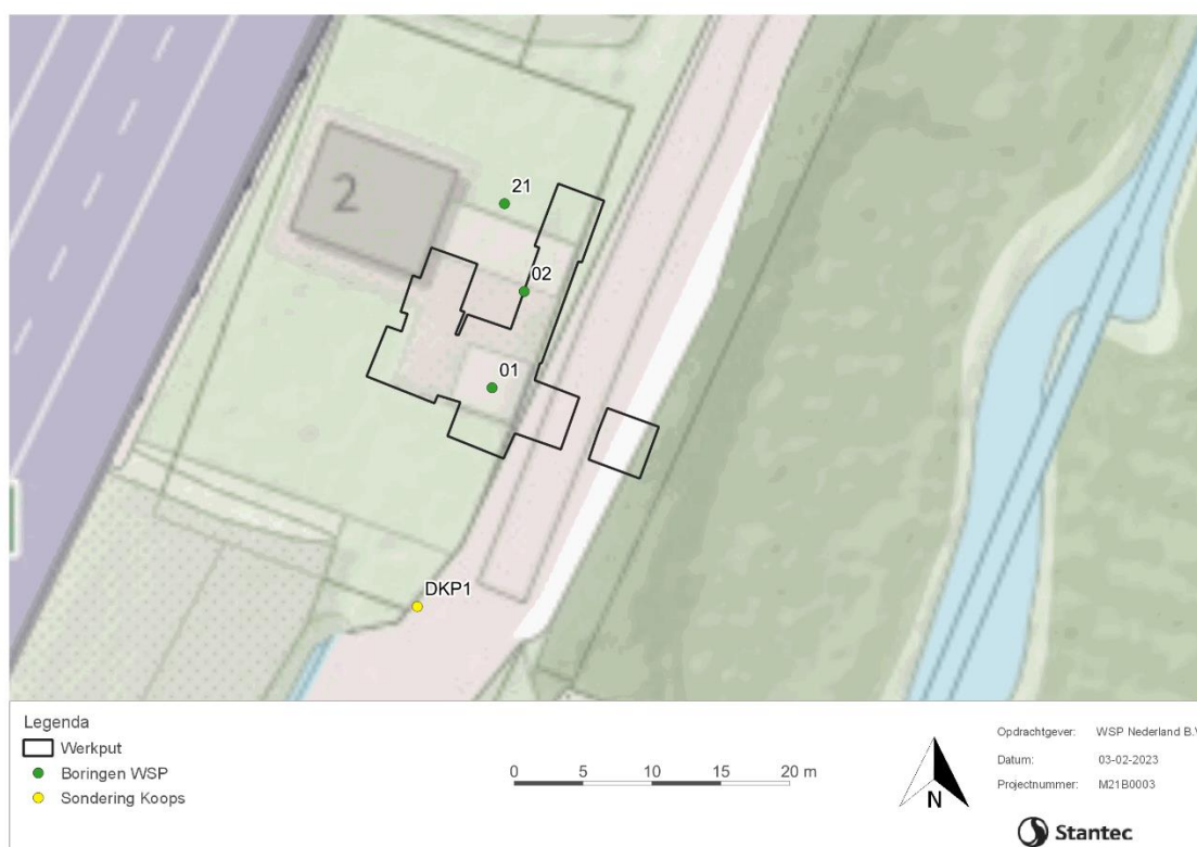
Figuur 1: Ligging van de werkputten. Eventuele representatieve boringen uit DINOloket zijn weergegeven in oranje, sonderingen in geel, peilbuizen uit DINOloket in blauw en lokale boringen en peilbuizen zijn weergegeven in groen.
