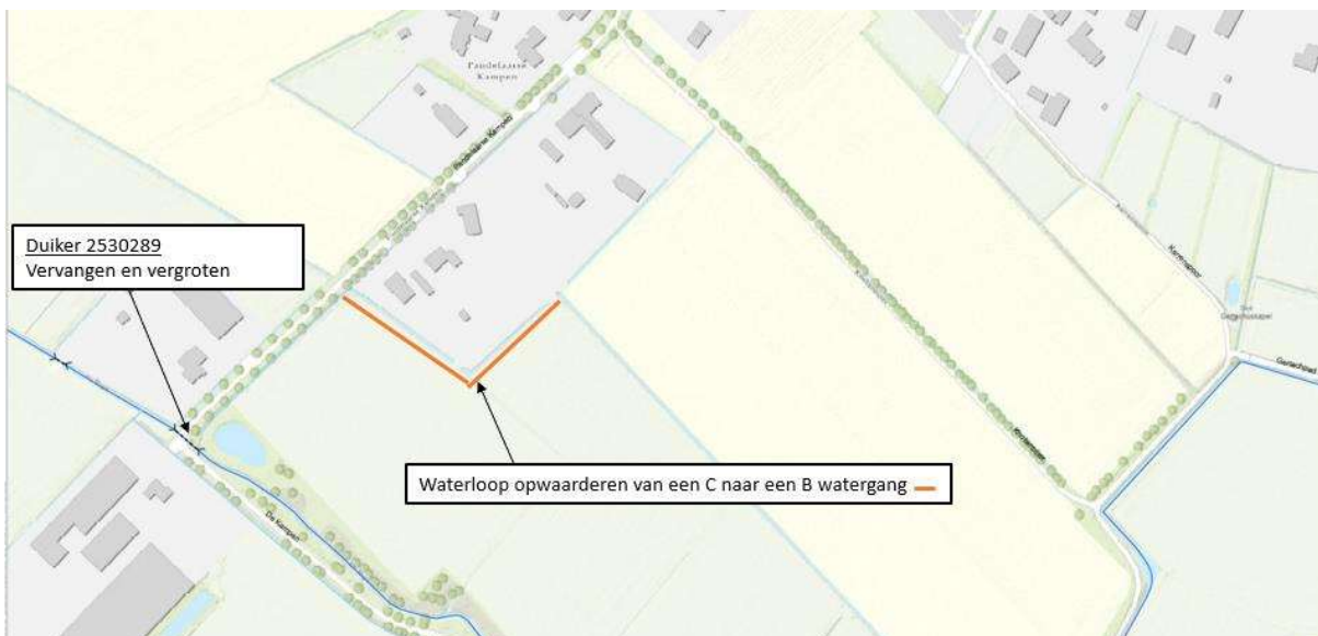
Figuur 3.2: Projectplanplichtige werkzaamheden Pandelaarse Kampen
