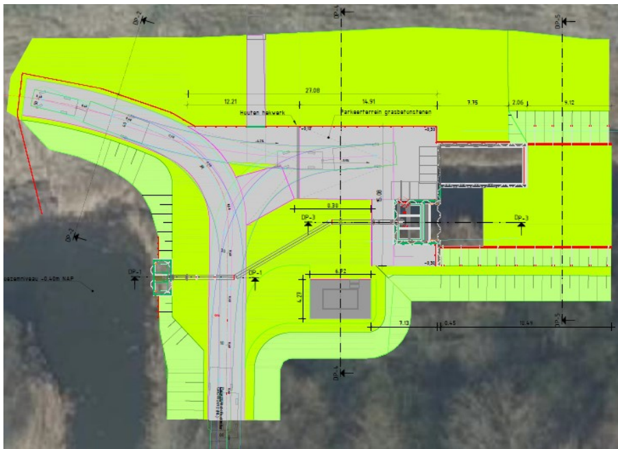
Figuur 2 bovenaanzicht gemaal met maatvoering
