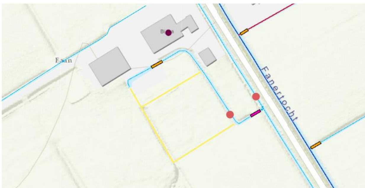
Figuur 1: Werkgebied met in het geel de nieuw te graven watergangen en in het rood de aan te leggen dammen
