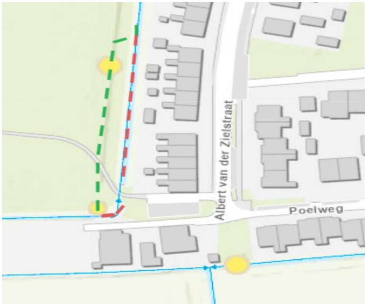
Figuur 1: Te dempen watergang weergegeven met rode stippellijn, te graven watergang weergegeven met groene stippellijn, aan te leggen dammen met duikers weergegeven met gele cirkels.
