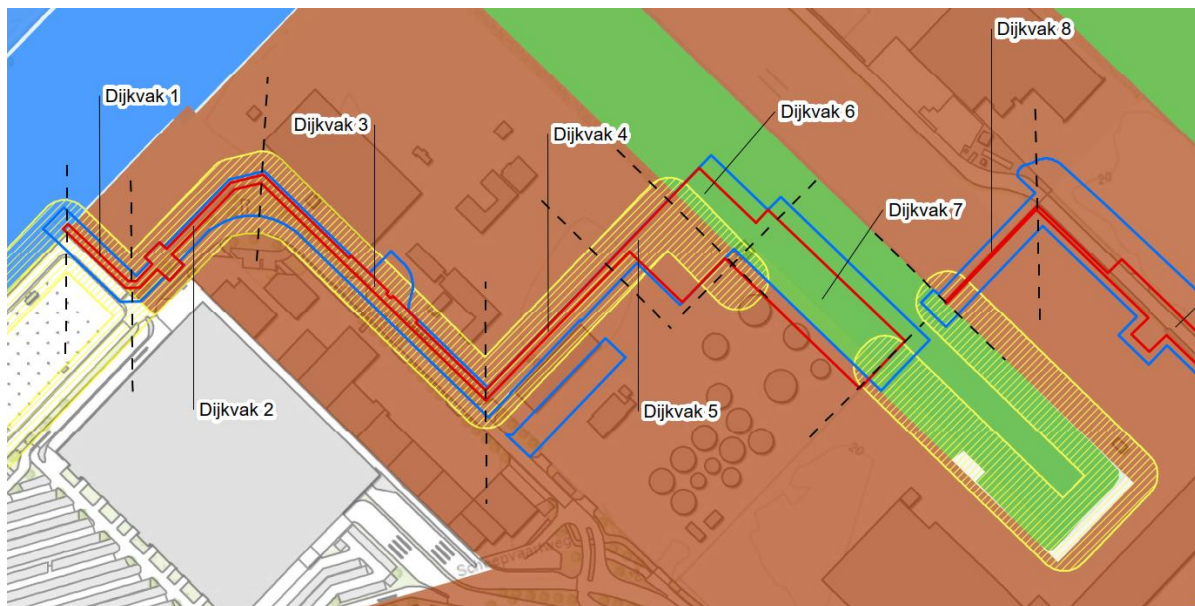
Figuur 6 Permanent (rode lijn) en tijdelijk (blauwe lijn) ruimtebeslag en ligging dubbelbestemming Waterstaat (gele arcering)
