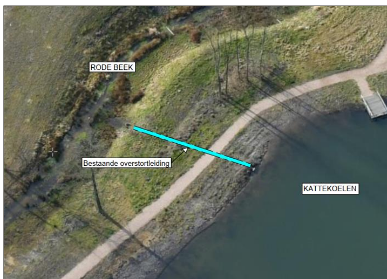
Afbeelding 4: Situatie bestaande overstortleiding Kattekoelen op Rode Beek
