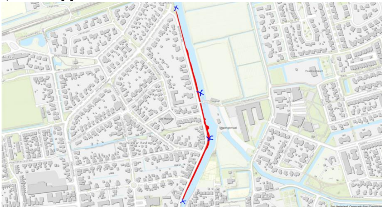
Figuur 2: in het blauw globaal de plaatsaanduiding van de aan te brengen scheepvaartborden. Bij de middelste twee locaties dienen de borden tweezijdig te worden aangebracht.
