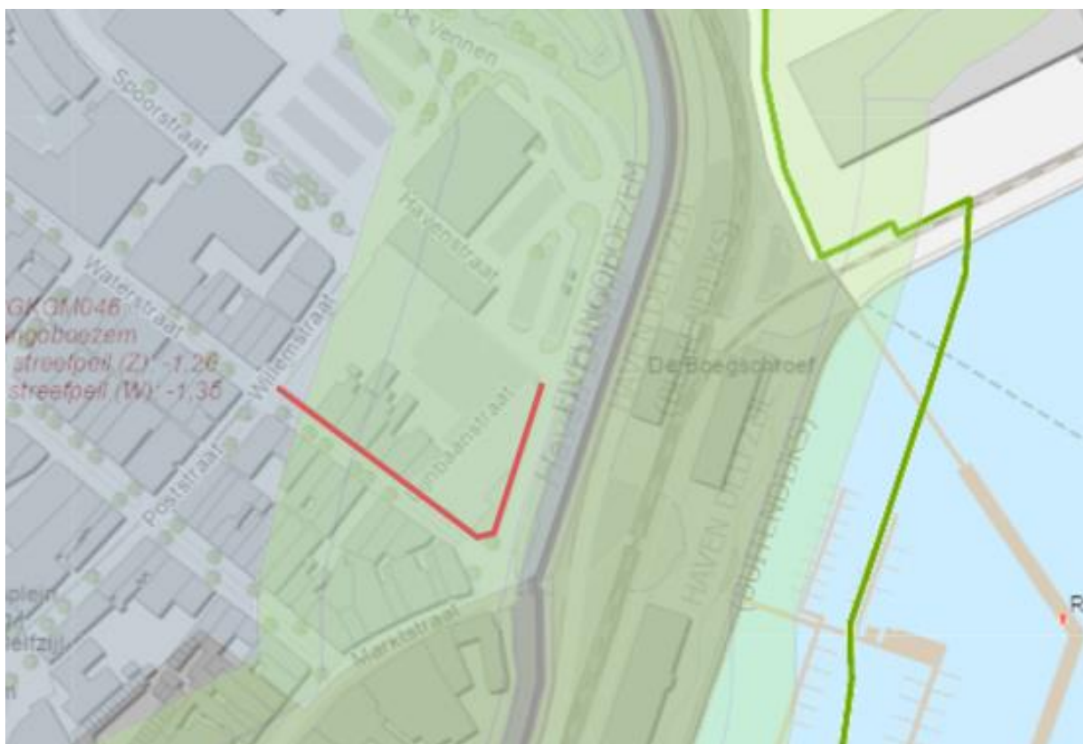
Figuur 1: Schematische tekening van de werkzaamheden. De rode lijn geeft globaal de locatie weer van het aan te leggen glasvezeltracé.
