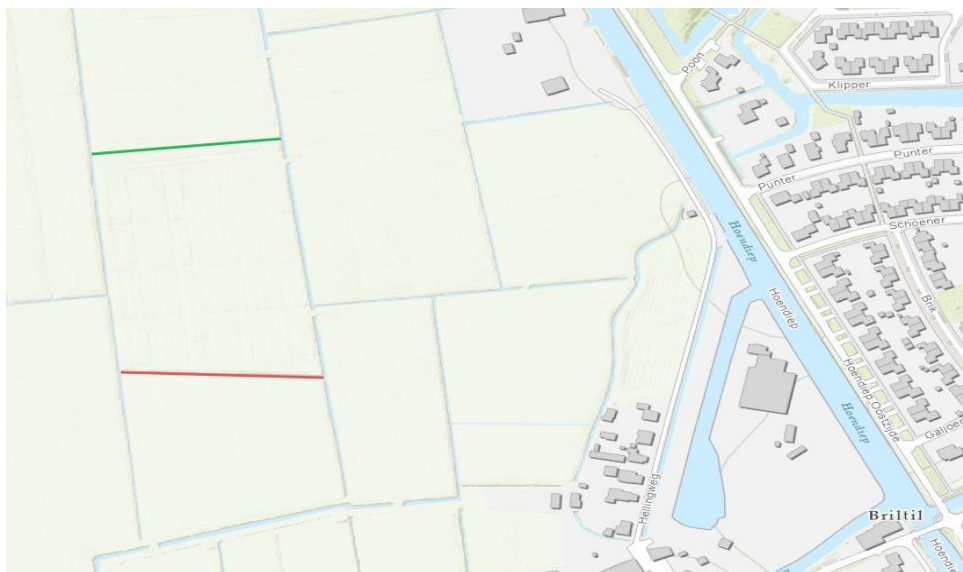
Figuur 1: Locatie van werkzaamheden. De rode lijn geeft te dempen watergang weer. De groene lijn geeft nieuw te graven watergang weer.
