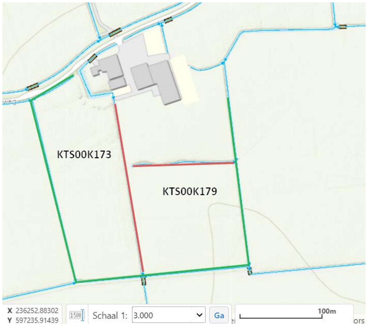
Figuur 1: Schematische tekening werkzaamheden. De rode lijnen zijn de te dempen watergangen, de groene lijnen zijn de te verbreden watergangen.
