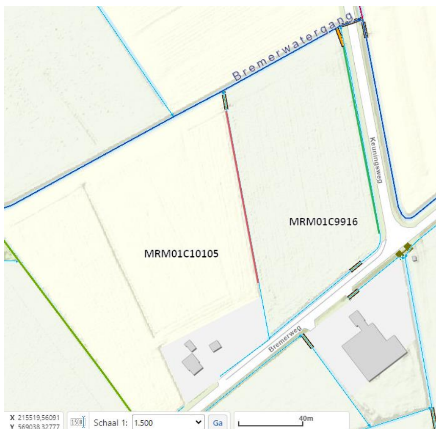
Figuur 1: Schematische tekening werkzaamheden. De rode lijn geeft de te dempen watergang weer, de groene lijn is de te verbreden watergang.
