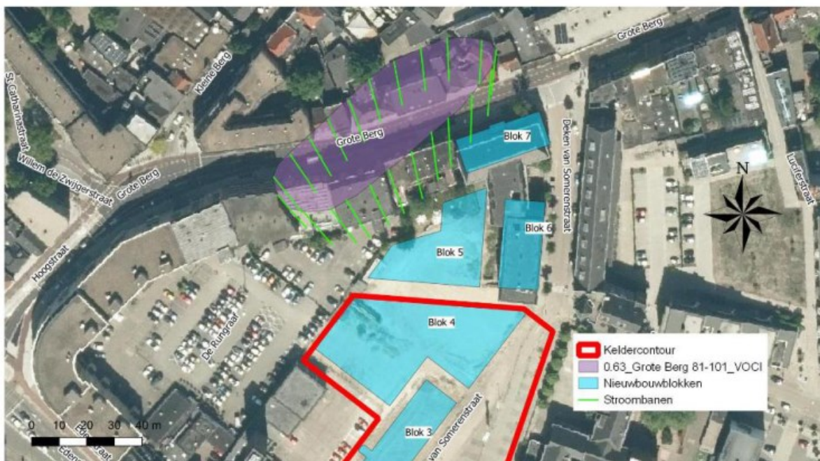
Figuur 13. Stroombanen na 231 dagen bemalen gedurende een relatief hoge grondwaterstand van 15,9 m + NAP.
