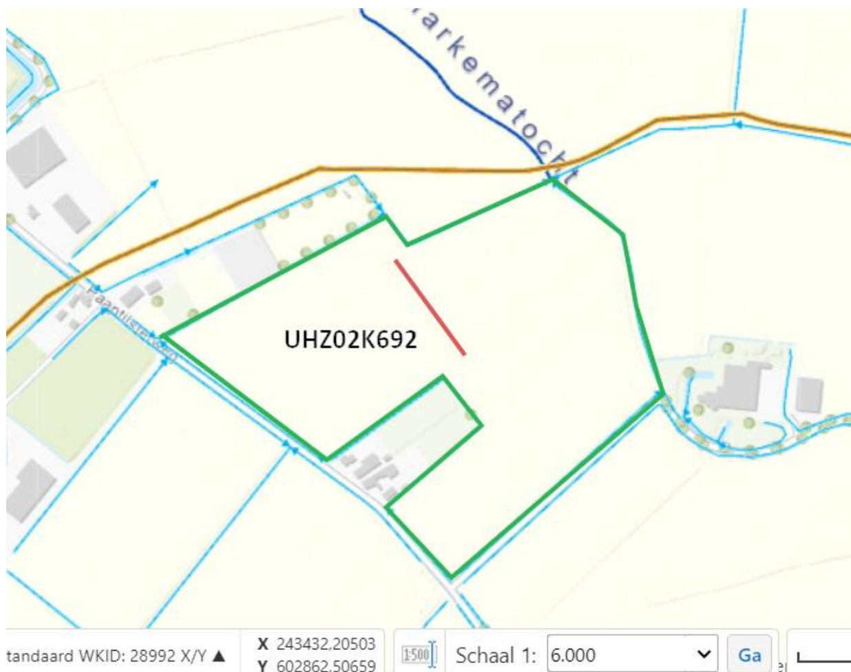
Figuur 1: Schematische tekening van de werkzaamheden. De rode lijn geeft de te dempen watergang weer, de groene lijn zijn de omliggende watergangen die worden verbreed.
