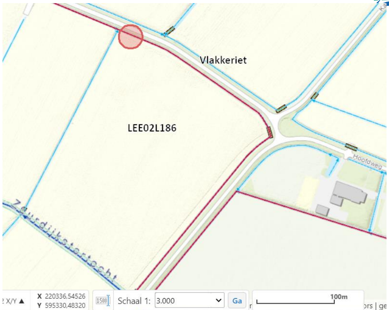
Figuur 1: Schematische tekening werkzaamheden. De rode cirkel geeft globaal de locatie weer van de aan te leggen dam met duiker.
