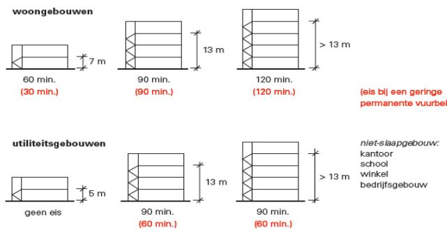
Conform het bouwbesluit 2012 geldt voor het gedeelte met de appartementen, een brandwerendheidseis van 120 minuten.
