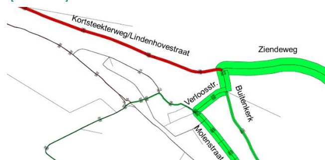
Figuur 9: Verschilplot werkdag etmaal, met en zonder afsluiting Zierendeweg (groen = afname als gevolg van afsluiting Zierendeweg, rood = toename als gevolg van afsluiting Zierendeweg)
