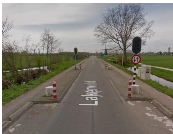
Figuur 58: Voorbeeld VRI t.b.v. sluipverkeer; Lakerveld Meerkerk (sluiproute A27). Bron: Google Streetview
