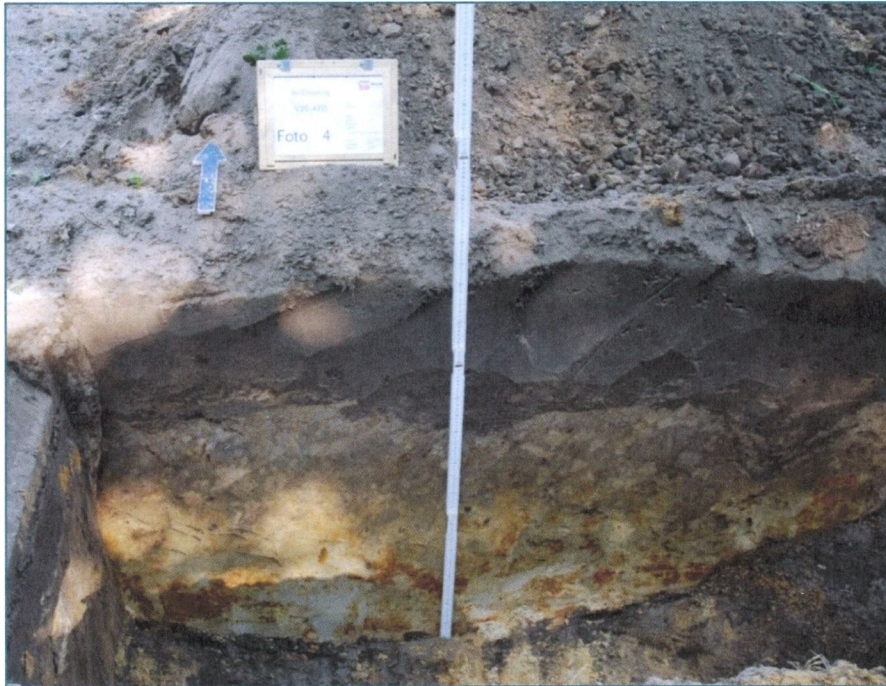
Afbeelding 5 Noord-profiel van profielput 4355204 (Bron: Vestigia). Het meest opvallende kenmerk is hier het roestige humusarme uitgangsmateriaal (Cg) onder het geroerde materiaal (bouwvoor en geroerde grond). De profielbeschrijving is opgenomen in bijlage 3 .
