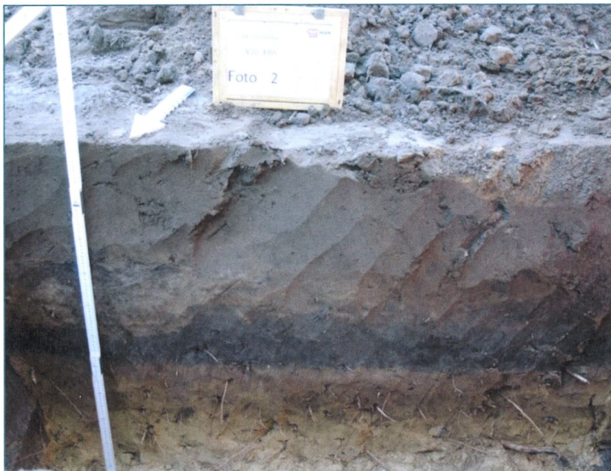
Afbeelding 2 Zuid-profiel van profielput 4355202 (Bron: Vestigia). Onder de uit twee delen bestaande, in totaal 62 cm dikke geroerde toplaag is nog een deel van het oorspronkelijke podzolprofiel aanwezig. De profielbeschrijving is opgenomen in bijlage 3 .
