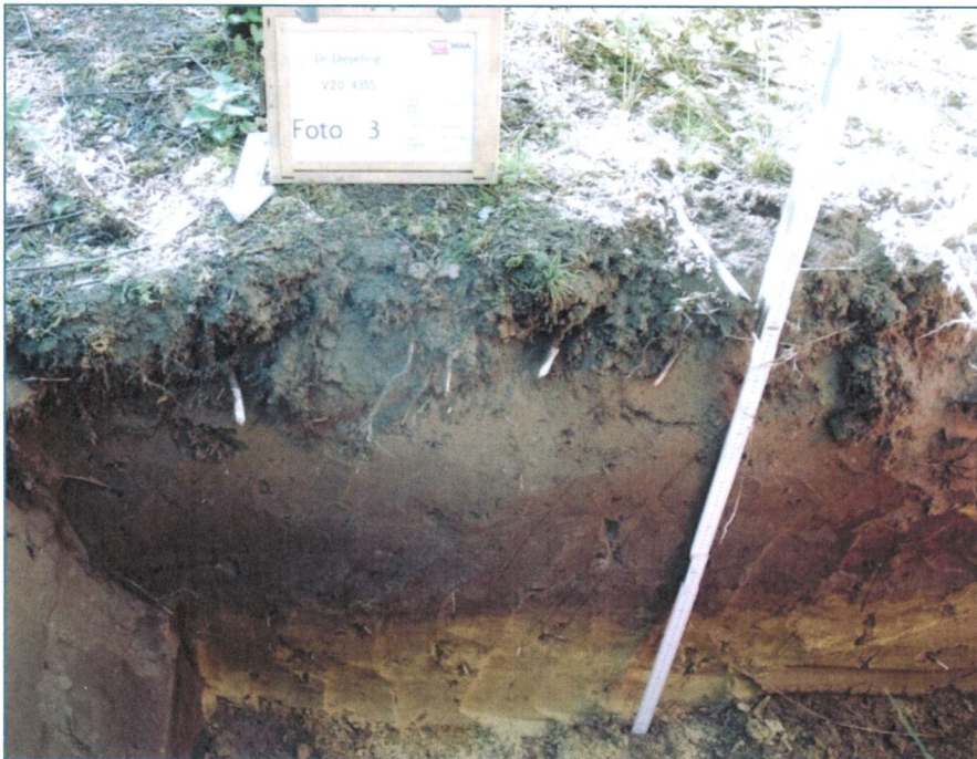
Afbeelding 4 Zuid-profiel van profielput 4355203 (Bron: Vestigia). Onder de uit twee delen bestaande, in totaal 64 cm dikke geroerde toplaag is nog een deel van het oorspronkelijke podzolprofiel aanwezig. De profielbeschrijving is opgenomen in bijlage 3 .
