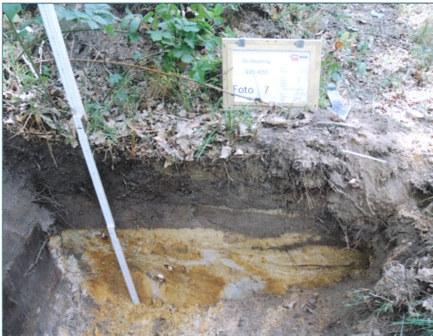
Afbeelding 8 Zuid-profiel van profielput 4355207 (Bron: Vestigia). Het meest opvallende kenmerk is hier het roestige humusarme uitgangsmateriaal (Cg) direct onder de bouwvoor. De profielbeschrijving is opgenomen in bijlage 3 .
