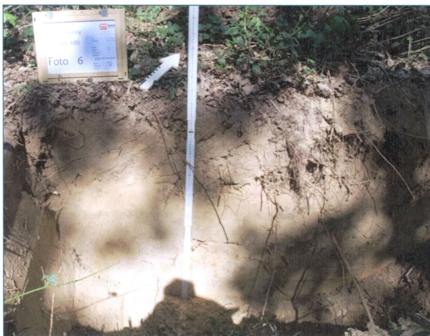
Afbeelding 7 Noord-profiel van profielput 4355206 (Bron: Vestigia). Het zwak roestige humusarme uitgangsmateriaal bevindt zich hier direct onder de bouwvoor. De profielbeschrijving is opgenomen in bijlage 3 .
