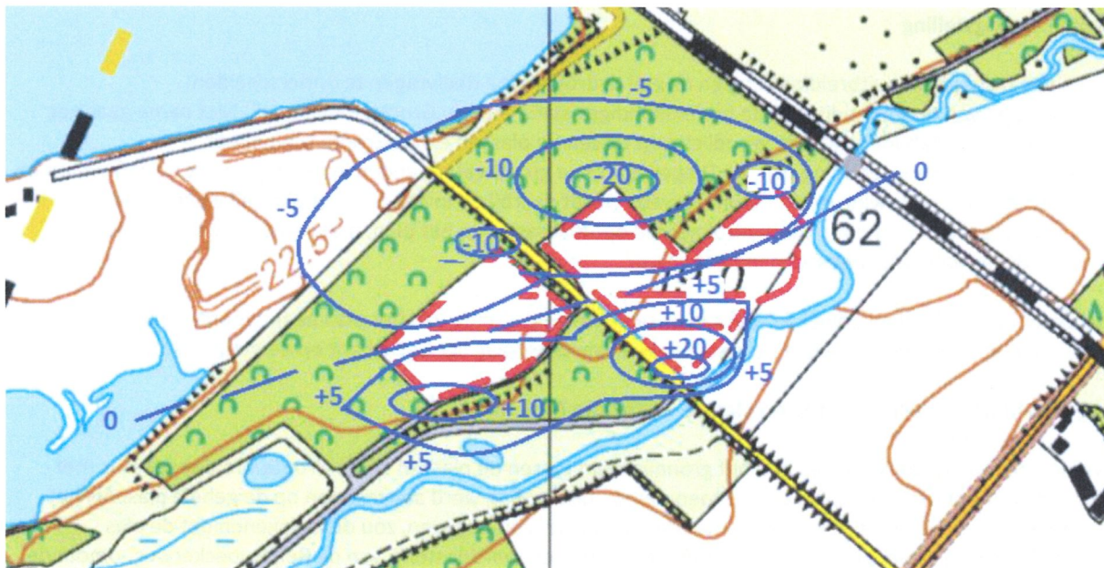
Figuur 4. Verhogingen en verlagingen van de grondwaterstijghoogten als gevolg van de zandwinning, bij de aanwezigheid van plassen zonder (inrichtings)maatregelen.
