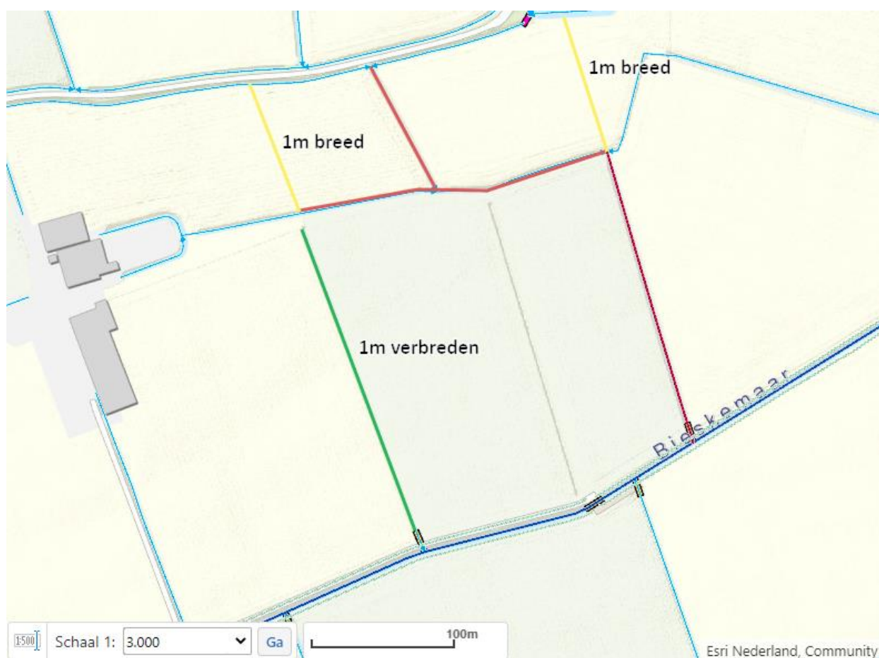
Figuur 1: De rode lijnen geven de te dempen secundaire watergangen weer, de groene lijn geeft de te verbreden watergang weer, de gele lijnen zijn de nieuw te graven watergangen.
