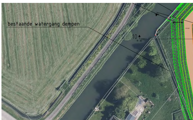
Figuur 11: Bovenaanzicht te dempen watergang en nieuw te graven watergang
