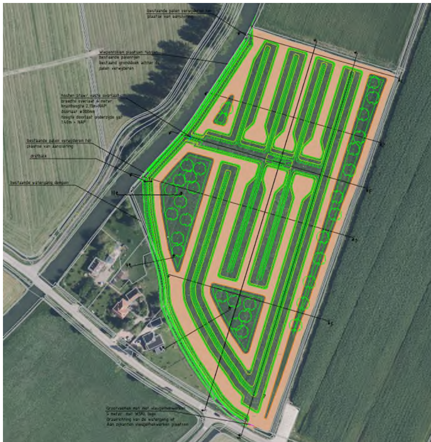
Figuur 9: Bovenaanzicht klimaatbuffer Hogestraat Zoelen ( bruin geaccentueerd is het onderhoudspad, groen geaccentueerd is de klimaatbuffer).
