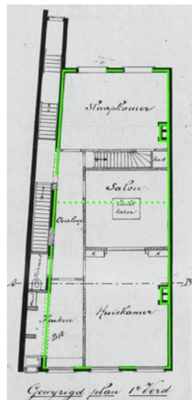
Afb. 14: De ingrepen van 1936 reikten verder dan alleen de moderne voorgevel. Het achterhuis kreeg een aanbouw met keuken. De verbindingsgang werd aangepast (al in 1916 verhoogd, zie ook afb. 13), waarbij de trap vanuit de gang naar de verdieping verviel, enzovoorts. [Stadsarchief Breda]
