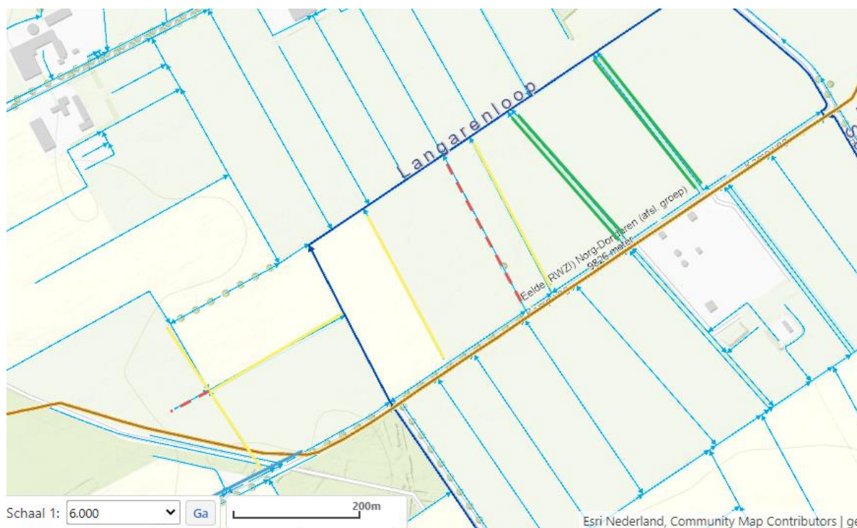
Figuur 1: De groene lijnen zijn de te verbreden watergangen, de rode stippellijnen zijn de te dempen watergangen. De gele lijnen geven de her te profileren watergangen weer.
