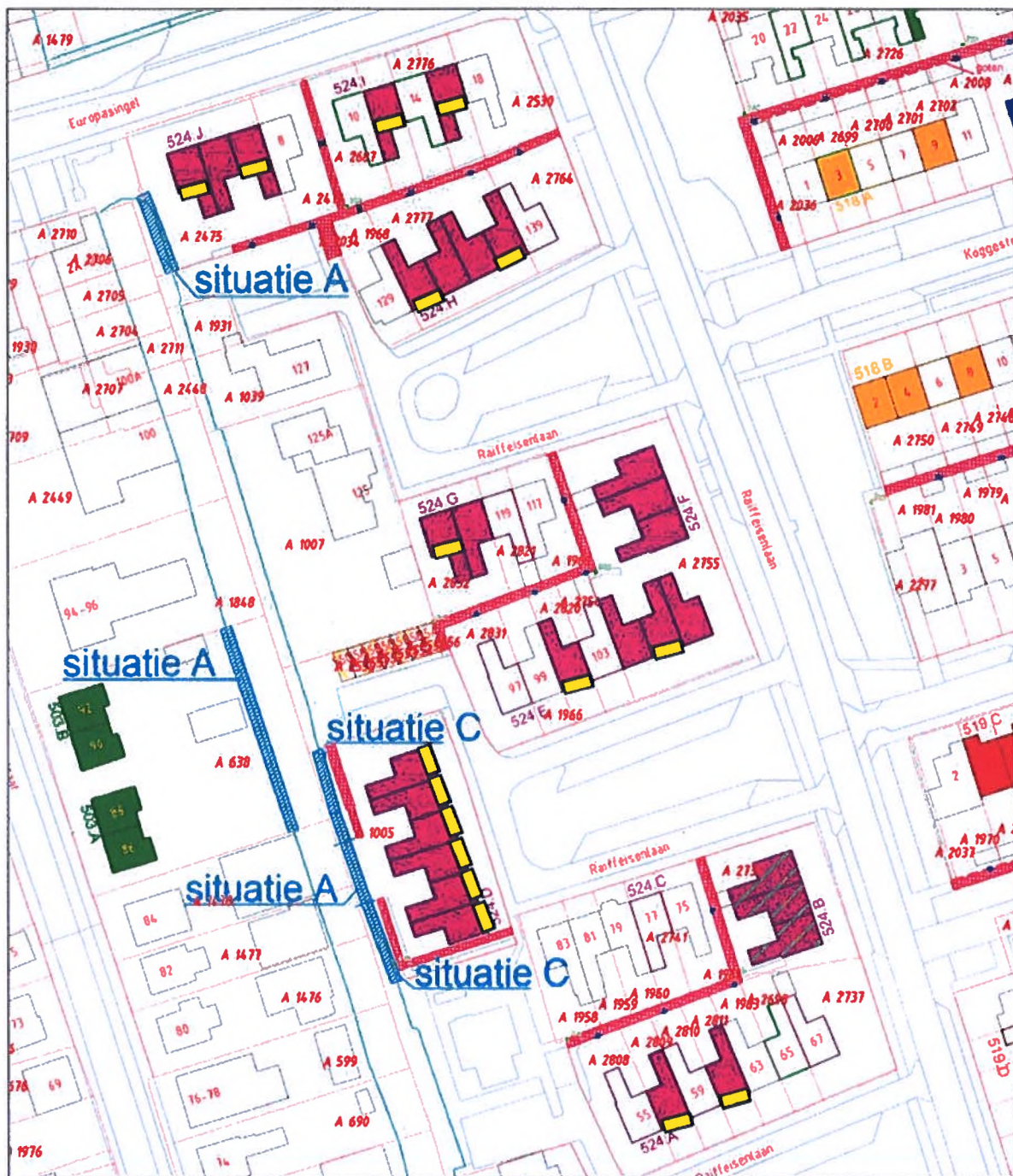
Afb 6: Verspreid over de woonblokken wordt op de zuid en oostgevels 17 dubbele kasten onder de goot aangebracht
