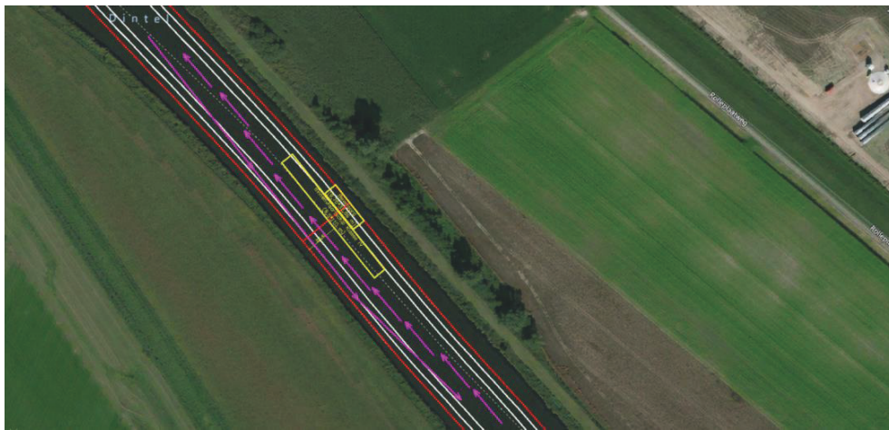
Figuur 1: Situatie met baggerwerkzaamheden aan stuurboordzijde van De Dintel (vrij ruimte vaargeul: ca 23 meter)
