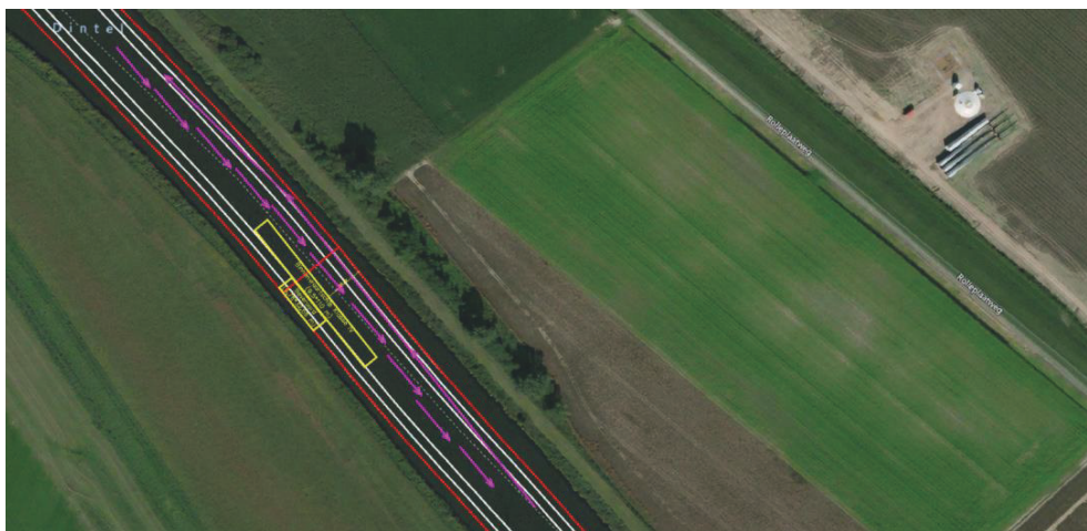
Figuur 2: Situatie met baggerwerkzaamheden aan bakboordzijde van De Dintel (vrij ruimte vaargeul: ca 23 meter)
