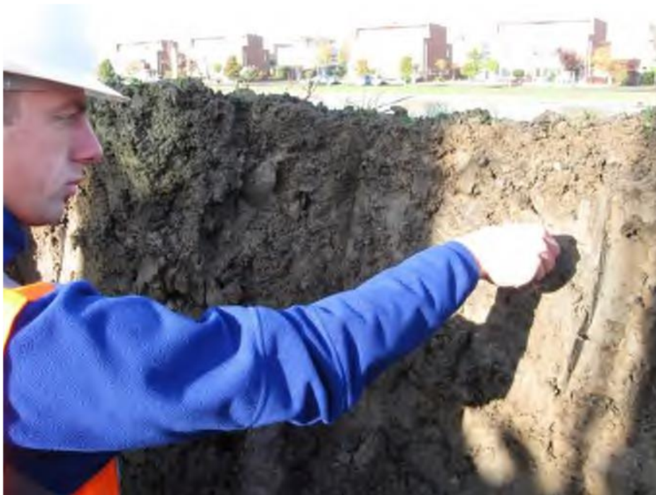
Figuur 10 analyse gestructureerdheid klei middels een proefkuil
