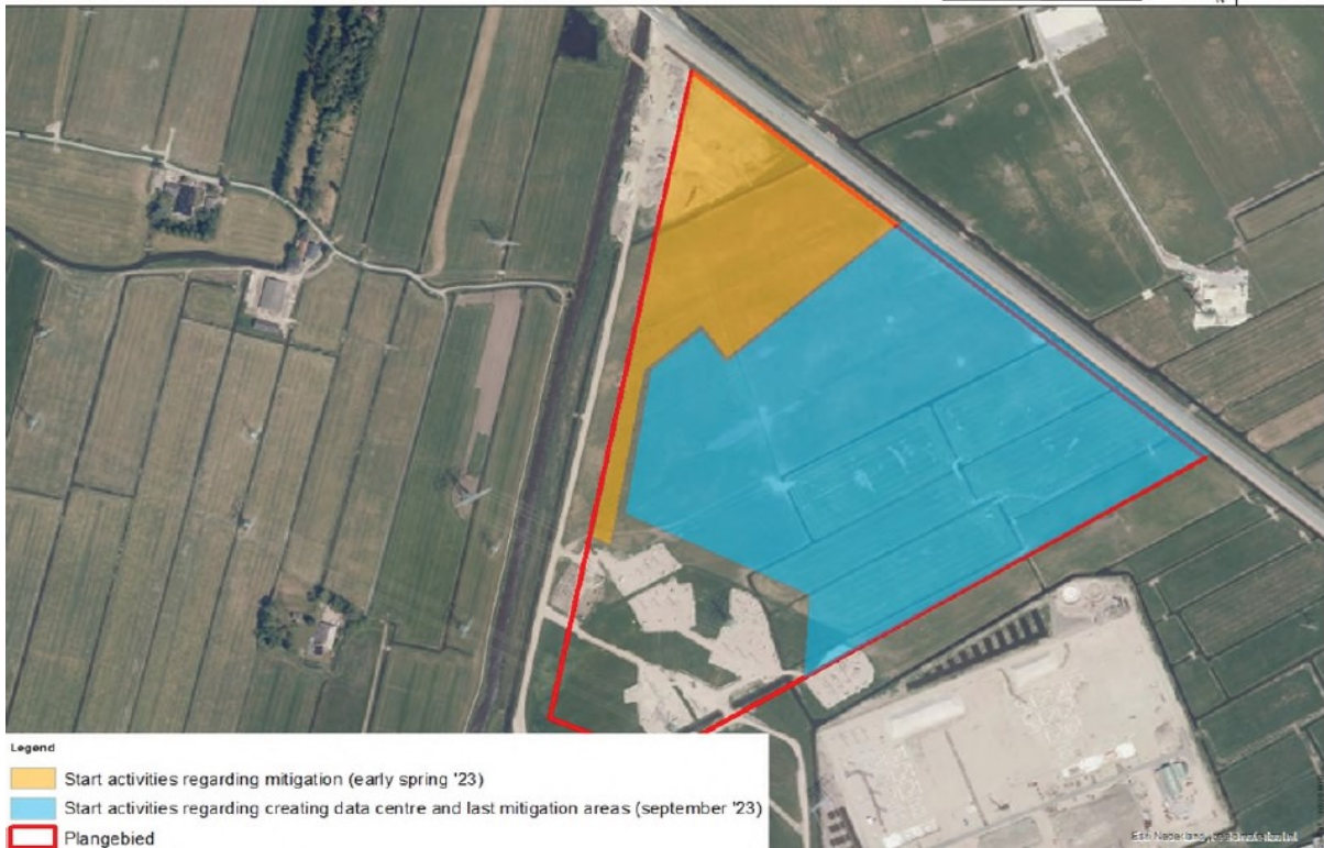
Figuur 3. Fasering van de werkzaamheden in het plangebied. De exacte grenzen dienen nog op een later tijdstip bepaald te worden. Fase 1 betreft het oranje gebied en fase 2 het blauwe gebied. Er is een scheiding gemaakt tussen de werkzaamheden voor mitigatie en compensatie (alternatief leefgebied, fase 1) en de werkzaamheden voor de realisatie van het datacentrum (fase 2).
