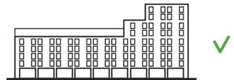
Plinten zijn onderscheidend maar doen wel mee met de ritmiek van de gevel en lopen in principe door tot aan de grond
