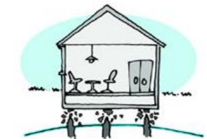
Grondwaterpeil te laag: paalrot
