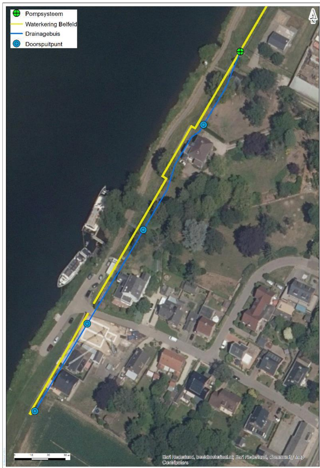
Figuur 11 Ligging drainagesysteem
