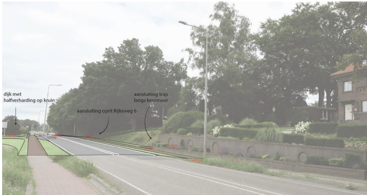
Figuur 3-11 Aansluiting op de Rijksweg, inclusief ophoging
