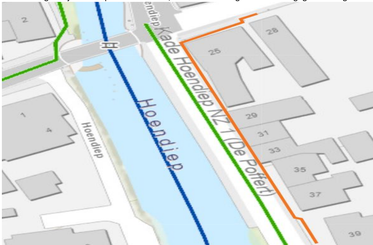
Figuur 1: Gewenste tracé (ribbuis met telecomkabels) weergegeven met oranje lijn.
