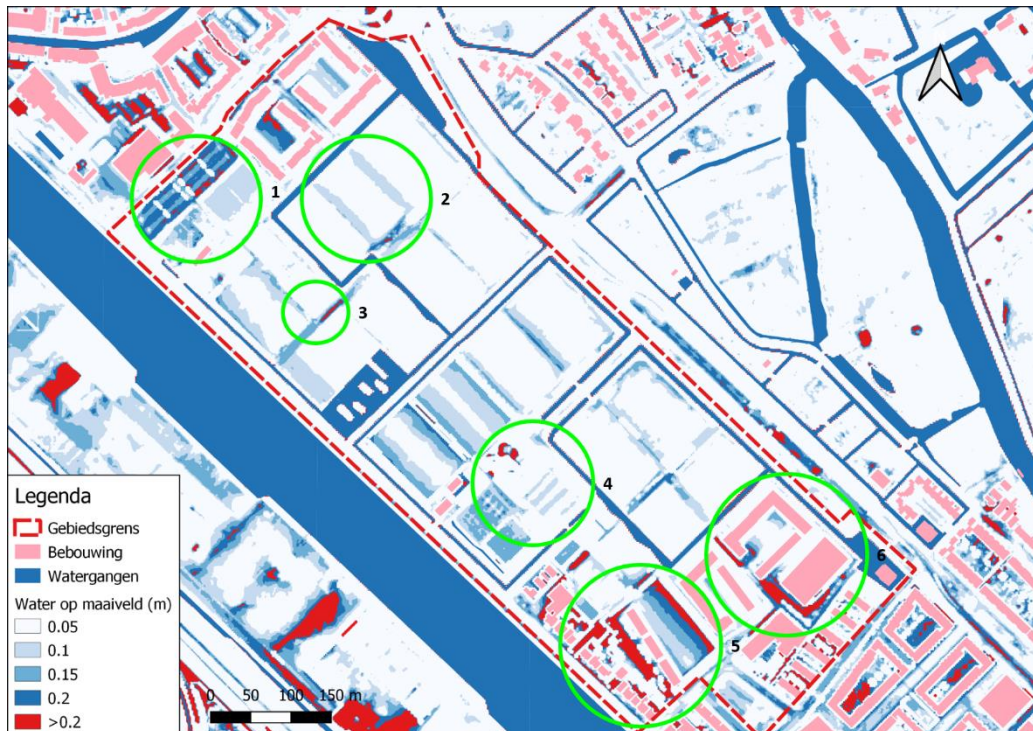
Figuur 8 Maximale waterdieptes op maaiveld voor de nieuwe situatie in het 80 mm scenario. De groene cirkels geven gebieden van aandacht aan.
