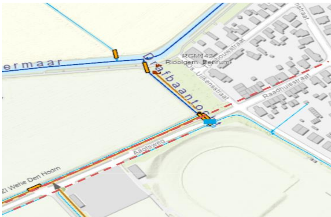
Figuur 1: Ingediende tekening 1, 2x kruising persleiding.
