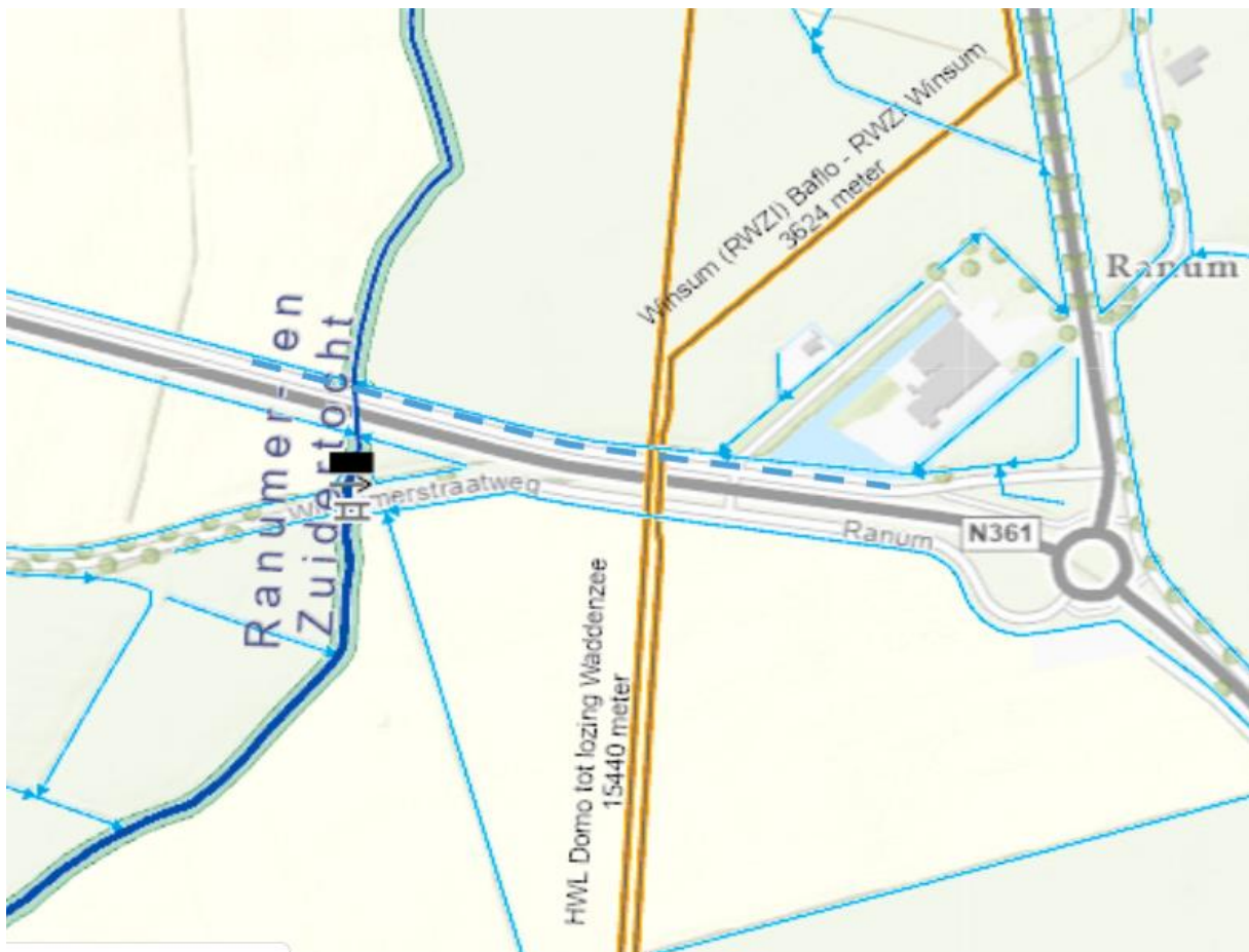
Figuur 3: Ingediende tekening 5, 2x kruising persleiding.
