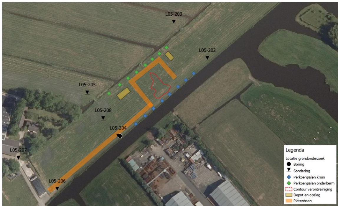
Figuur 2-2: Bovenaanzicht saneringslocatie met platenbaan en perkoenpalen
