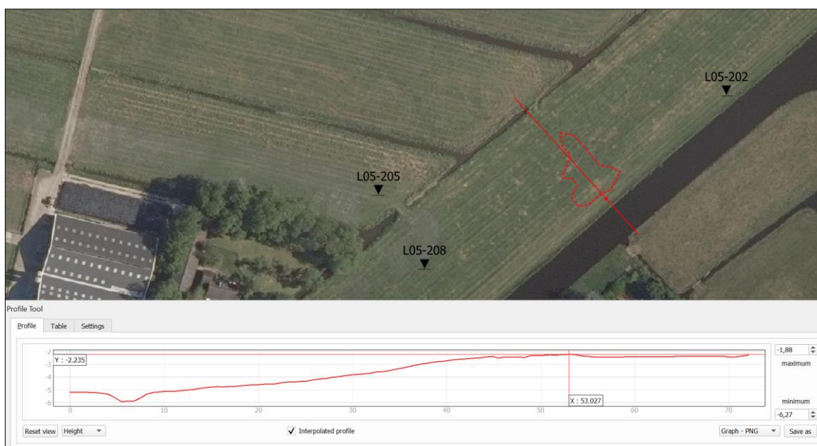
Figuur 2-1: Bovenaanzicht en dwarsprofiel over dijklichaam conform AHN3
