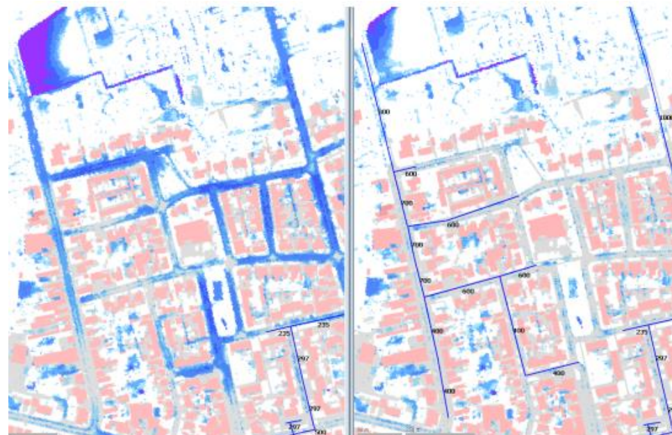
Dit is een weergave van een bui van 70 mm in een uur. Links is de huidige situatie weergegeven, rechts de situatie na toepassing van maatregelen zoals opgenomen in het GRP. Bron: Bijlage III Gemeentelijk rioleringsprogramma 2023-2026
